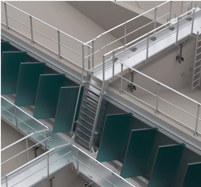
Kruising van een trapladder, brug en trap.
