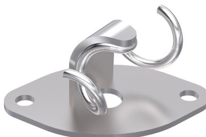
REF : 102270 Intermédiaire inox V3. Tous les 15 mètres maximum. Entraxe : 2 trous 141 mm. Fixation : M10 ou M12
