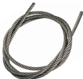
REF : 100150 Câble inox diamètre 8 mm 7x19
