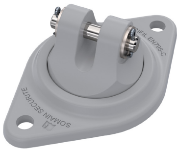
REF : 102441 Extrémité alu orientable V3. Entraxe : 2 trous 141 mm Fixation : M10 ou M12
