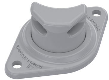
REF : 102442 Renvoi d'angle alu orientable V3. Tous les 15 mètres maximum. Entraxe : 2 trous 141 mm Fixation : M10 ou M12
