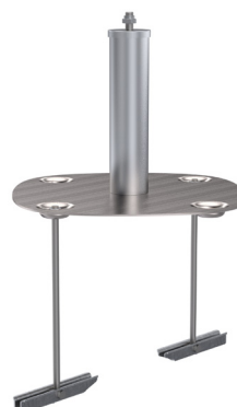
REF : 102430 Pfosten für Enden oder Ecken. Befestigung: 2 verzinkte Kippdübel Option: Kippdübel aus Edelstahl. Option: Dübel mit spezifischer Länge.
